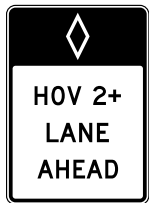
ຮູບ 2.6: ປ້າຍເສັ້ນທາງສະຫງວນໃນຕົວຢ່າງນີ້, ເສັ້ນທາງດັ່ງກ່າວແມ່ນສະຫງວນໄວ້ສໍາລັບຍານພາຫະນະທີ່ມີຜູ້ໂດຍສານຫຼາຍຄົນ (HOV) ທີ່ບັນທຸກຜູ້ໂດຍສານສອງຄົນ ຫຼື ຫຼາຍກວ່ານັ້ນ.
