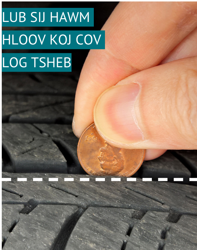
Duab 3.1: Siv lub nyiaj npib los ntsuam xyuas koj lub log tsheb cov hneev
