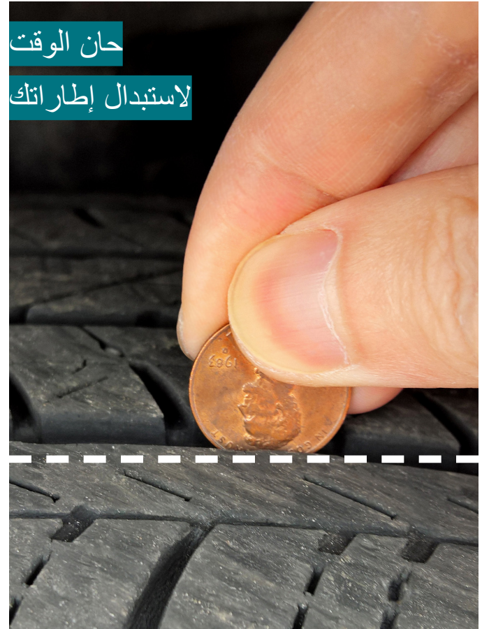
الشكل 3.1: تحقق من مداس الإطار الخاص بك مع بنس واحد
